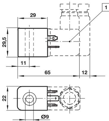
1 Gerätesteckvorrichtung 4 x 90° drehbar
