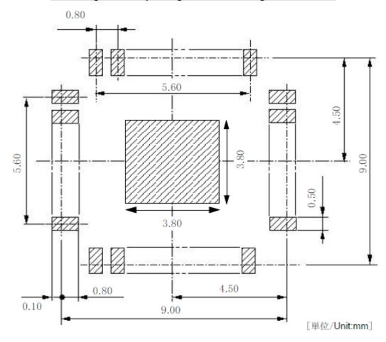
実装基板のフットバターンの設計の際には、実装の容易さ、接続の信頼性、配線の引き回し、 半田ブリッジ発生のないことなどを十分考慮してください。
