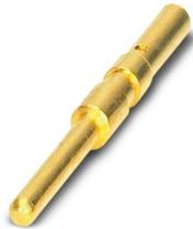
Crimpkontakt, Stift, gedreht, Kontaktdurchmesser: 1 mm, Crimpbereich: 0,08 mm<sup>2</sup> ... 0,5 mm<sup>2</sup>, Artikel ist bleifrei nach RoHS II ohne Ausnahme 6c (Pb < 0,1 %)
