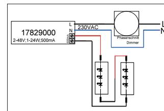
LED-Konverter 500 mA, Phasenabschnitt dimmbar. Dieses Betriebsgerät erfüllt die Anforderungen für Sicherheitsbeleuchtungsanlagen nach DIN EN 50172 VDE 0108-100:2005-01. Dieser Konverter ist durch Sicherungseinrichtungen gegen Überspannung und Kurzschluss sowie thermische und elektrische Überlastung geschützt. Die Eingangs- und die Ausgangsklemme ist für Leitungen mit einem Querschnitt von bis zu 2,5 mm<sup>2</sup> geeignet.
