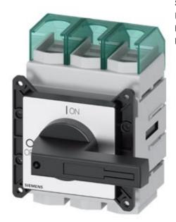
SENTRON, Lasttrennschalter 3LD5 UL, Hauptschalter, 3-polig, approbiert nach UL489, UL60947-4-1 und IEC60947-3, UL: 100A, SCCR 65kA at 480VAC, Betriebsleistung @ 480VAC 3-phasig: 60hp, IEC: 100A, Betriebsleistung bei AC-23A bei 400V: 45kW, Frontbefestigt: Drehantrieb, schwarz, 4-Loch Befestigung der Handhabe, inklusive Klemmenabdeckungen für die Einspeiseseite
