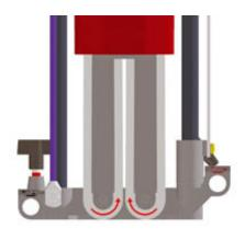
Zwei gegenläufige Spezialfräsketten sorgen für ausrissfreies Arbeiten und optimalen Spänefluss.
