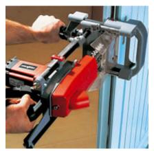
Jetzt kein Problem mehr: An einer eingebauten Tür ist das Einstemmen von Schlosskästen schnell und präzise möglich.
