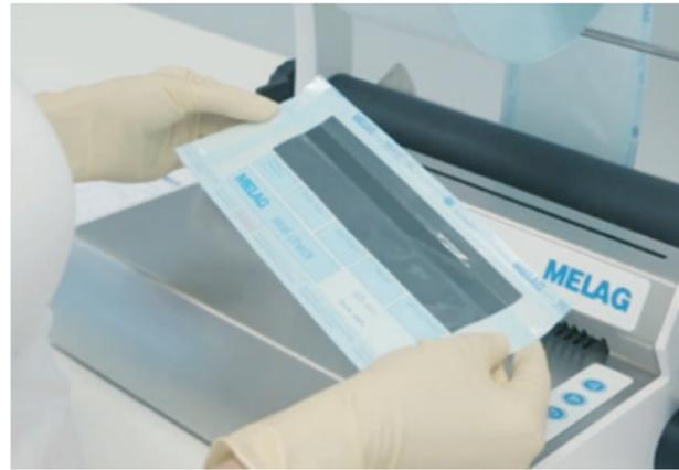
Der **wöchentlich** durchzuführende **MELAG seal check** verifiziert die Qualität der Siegelnaht nach DIN EN ISO 11607-2.
