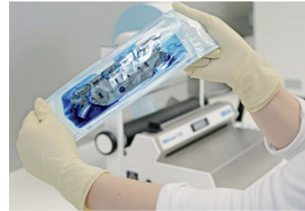
Der Tintentest **MELAink** ist ein zuverlässiges Prüfmittel zur **wöchentlichen** Kontrolle der Siegelnähte auf Dichtigkeit gemäß DIN EN ISO 11607-1 und ASTM F1929-12.
