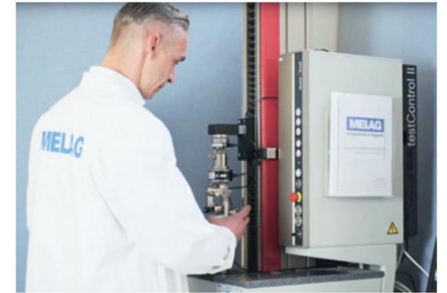
Als Routinekontrolle und zur Validierung von Verpackungsprozessen mit MELAG Siegelgeräten empfehlen Hygieneexperten die **jährliche** Überprüfung der Siegelnähte auf Zugfestigkeit.
