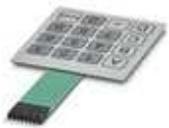
Folientastatur selbstklebend in Silberleittechnik, 16 Tasten, hochgeprägt, 3 Farben, Anschlusskabel: 62 mm, mit Crimp-Buchse female Rastermaß: 2,54mm, Einsatztemperatur: -20 °C ... 70 °C
