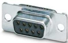
D-SUB-Kontakteinsatz, Shell-Größe 1, mit 9 Signalkontakten, Kontaktart Buchse, mit Lötkelch, gerade, Befestigung mittels Bohrung 3 mm, für Anbaurahmen und Tüllengehäuse VS-09-...
