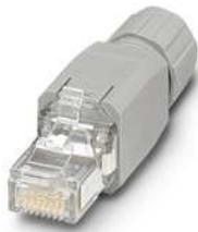
RJ45-Steckverbinder, Schutzart: IP20, Polzahl: 8, 1 GBit/s, CAT5 (IEC 11801:2002), Material: Kunststoff, Anschlussart: IDC-Schnellanschluss, Anschlussquerschnitt: AWG 26- 23, Kabelabgang: gerade, Farbe: verkehrsgrau A RAL 7042, Ethernet
