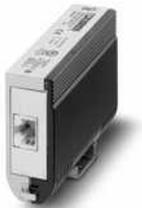
Überspannungsschutz gem. Class E<sub>A</sub> (CAT6<sub>A</sub>), für Gigabit-Ethernet (bis 10 GBit/s), Token Ring, FDDI/CDDI, ISDN, DS1. Geeignet für Power over Ethernet (PoE++ / 4PPoE) "Mode A" und "Mode B". RJ45-Zwischenstecker mit separater Erdungsleitung und Erdanschlussrastfuß für Tragschienen NS 35.
