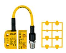
RFiD Sicherheitsschalter 2 sichere HL-Ausgänge, 5-pol. M12 Stiftstecker, eine Betätigungsrichtung, IP67, Schaltabstand 11 mm, Sao = 8 mm, Sar = 20 mm, VP = 1 Stück codierter Schalter mit Betätiger.
