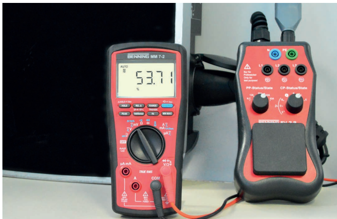
Tastverhältnismessung des CP-Steuersignals einer Wallbox
