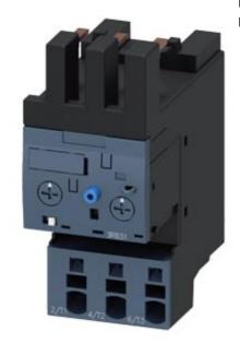
Überlastrelais 6...25 A elektronisch für Motorschutz Baugröße S0, CLASS 5...30 Schützanbau Hauptstromkreis: Federzugklemme Hilfsstromkreis: Federzugklemme Hand-Automatik-RESET interne Erdschlusserkennung
