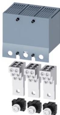
Rundleiteranschlussklemme TA2.6 6 x 14 AWG...2 AWG für 6 Kabel 3 Stück; inkl. Klemmenabdeckung verlängert mit Löchern zur Spannungsprüfung; Zubehör für: 3VA6 150/250 Steck-/Einschubsockel 3VA6 150/250
