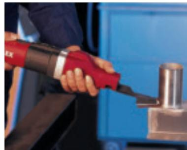
*Lineares Schliffbild bis in die Ecke. Der Fingerschleifer mit seiner Linearbewegung macht's möglich.*
