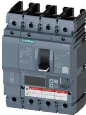
Leistungsschalter 3VA6 UL Frame 150 Schaltvermögenklasse H 65kA @ 480V 4-polig, Anlagenschutz ETU850, LSI, In=40A Überlastschutz Ir=16A...40A Kurzschlusschutz I<sub>sd</sub>=0,6..10x I<sub>n</sub>, I<sub>i</sub>=1,5..12x I<sub>n</sub> N-Leiterschutz einstellbar (OFF, bis 160%) ohne Anschluss
