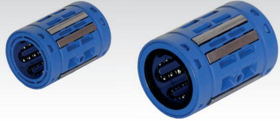
Kugelbuchse in Premium-Qualität. Hohe Tragfähigkeit auf Grund der unsymmetrischen Verteilung der Kugelreihen und der profilierten Laufbahnsegmente. Diese Linearkugellager können sowohl in geschlossenen als auch in geschlitzten Gehäusen eingebaut werden und sind somit einstellbar.
