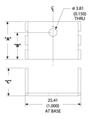
A Dim **18.03** B Dim **12.32** C Dim **12.70**
