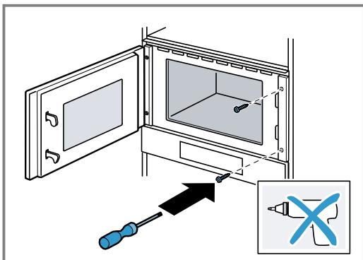
5. De gaten voor het bevestigen aan de kant van de scharnieren in het meubel voorboren.
