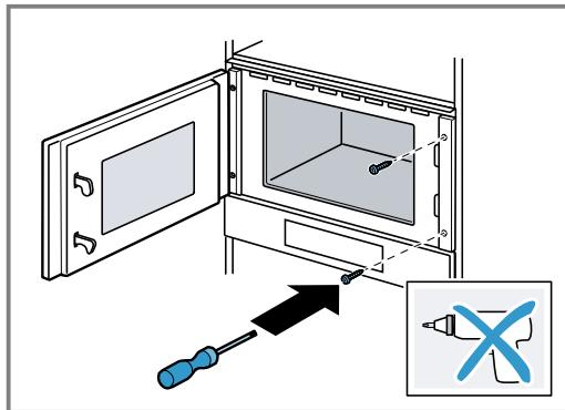
5. Preforare i fori per il collegamento a vite sul lato delle cerniere del mobile.
