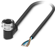
Sensor-/Aktor-Kabel, 5-polig, PUR halogenfrei, schwarzgrau RAL 7021, freies Leitungsende, auf Buchse gewinkelt M12 Push-Pull, Kodierung: A, Kabellänge: 5 m
