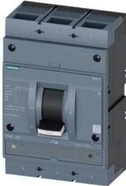
Leistungsschalter 3VA1 IEC Frame 1000 Schaltvermögenklasse C Icu=110kA @ 415V 3-polig, Anlagenschutz TM240, ATAM, In=800A Überlastschutz Ir=560A...800A Kurzschlusschutz Ii=5...10 x In Schraubenflachanschluss
