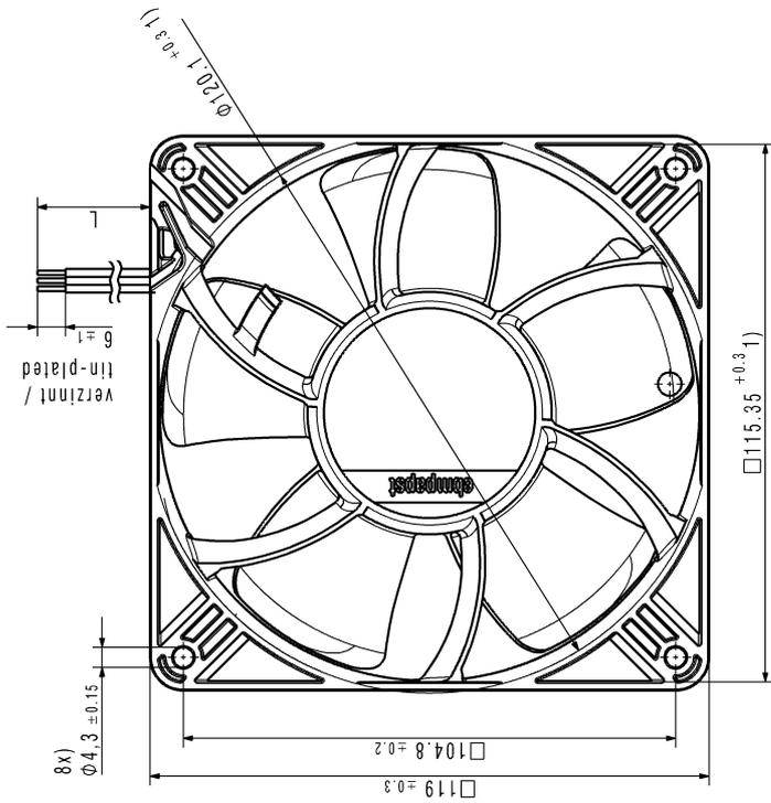
Rotorüberstand max. 0.4 / Rotor excess max.0.4 (a)
