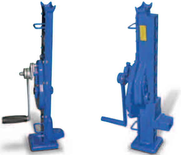
Veiligheidsslinger met dubbele pal. Bij rechtsom draaien wordt de last opgetild, bij linksom draaien neergelaten. Zelfremmend, de last wordt in elke positie vastgehouden.
