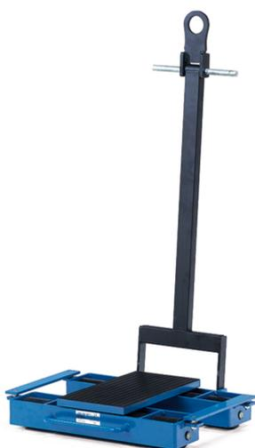
Rouleur pour le transport aisé et sûr de machines et autres objets lourds. Construction solide en acier avec poignée en tube d'acier, revêtement époxy bleu RAL 5007. Avec platine de support rotative et timon de traction. Grandes galets en nylon, roulement à billes. Livraison: 1 rouleurs avec platine rotative et timon de traction. Garantie: 2 ans.
