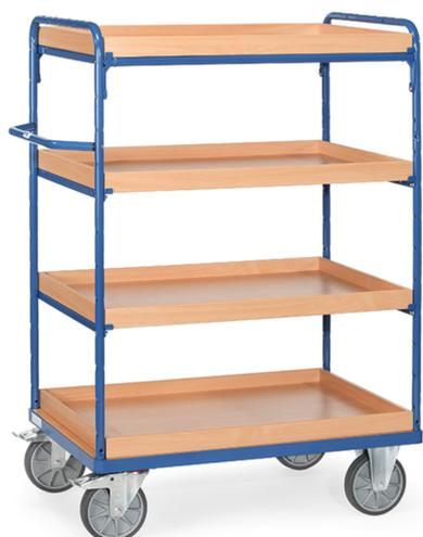
Ensemble mécano-soudé, revêtement époxy bleu RAL 5007. 1 caissette fixe et 3 amovibles en mélaminé surface effet hêtre. Caissettes amovibles réglables au pas de 100 mm. Charge maximum par caissette : 120 kg. 2 roues pivotantes et 2 roues fixes à bandage TPE, moyeu à roulement à billes central. Freins sur roues pivotantes conformément à la Norme EN 1757-3 (Sécurité des chariots de manutention).
