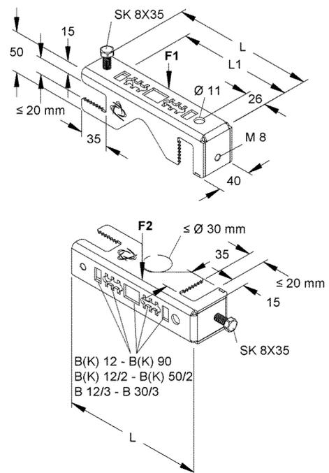
**S** Stahl, bandverzinkt nach DIN EN 10346
