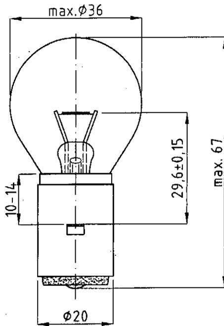
Neigung Socket Kolben max.3°
