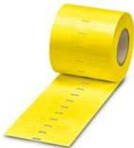
Einsteckschild, Rolle, gelb, unbeschriftet, beschriftbar mit: THERMOMARK E. 300 (D)/600 (D), THERMOMARK ROLL 2.0, THERMOMARK ROLL, THERMOMARK ROLL X1, THERMOMARK ROLLMASTER 300/600, THERMOMARK X1.2, Montageart: einlegen, Kabeldurchmesserbereich: 10 ... 25 mm, Schriftfeldgröße: 29 x 8 mm, Anzahl der Einzelschilder: 5400
