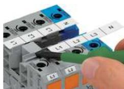
Zum Lösen der Brücken Beschriftungsstreifen seitlich verschieben.
