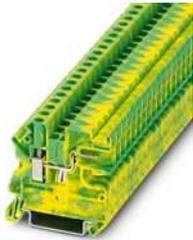
Schutzleiter-Reihenklemme, Anzahl der Anschlüsse: 2, Anschlussart: Schraub- / Steckanschluss, Querschnitt: 0,14 mm<sup>2</sup> - 6 mm<sup>2</sup>, Montageart: NS 35/7,5, NS 35/15, Farbe: grün-gelb
