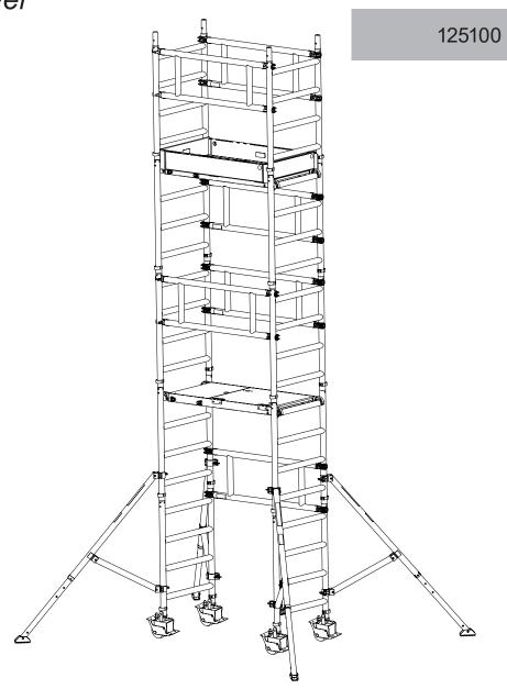
Fahrbare Arbeitsbühne nach DIN EN 1004 max. Arbeitshöhe 6,10 m
