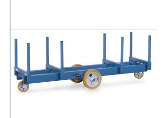
Profilstahl-Konstruktion mit einsteckbaren Stahlrohr-Rungen, 2 Materialmulden, pulverbeschichtet, blau RAL 5007. Mitte frei für Kran- oder Stapler-Beladung. Beräderung: Mittelradsatz, an den Stirnseiten je 1 Lenkrolle, Feststeller am Mittelradsatz. Gesamtbreite 700 mm, lichte Breite 600 mm.
