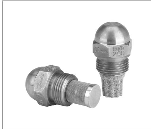
Die Öldüsen der Typen HFD/HD und SFD/SD sind für den Einsatz in Druckzerstäuberbrennern für Haushalt und Gewerbe konstruiert, für die Verwendung von Leicht- und Schwerölen. Die Stahldüsen sind erhältlich mit hohlem oder vollem Sprühmuster, in 3 verschiedenen Sprühwinkeln und mit Durchsätzen von 0,30 bis 2,50 US gal/h. Die Typen HFD und SFD haben zwei Sinterbronzefilter, wogegen die Typen HD und SD nur ein Sinterbronzefilter oder ein Monelfilter haben.
