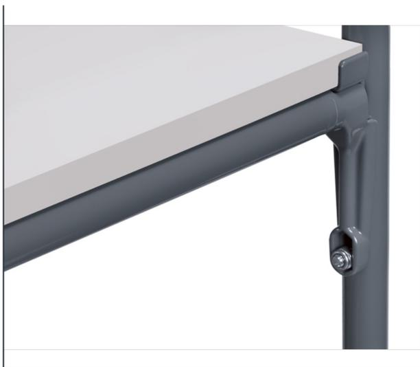
Ces entretoises électriquement conducteurs en gris foncé sont simplement vissées sous une étagère existante. Cela stabilise la structure et augmente la capacité de charge des étagères. Grâce au soutien, la tablette qui se trouve au-dessus des entretoises de renfort supporte 110 kg au lieu de 50 kg. La conductivité électrique est alors conservée. 1 paire est déjà fournie par chariot à plateaux ESD.
