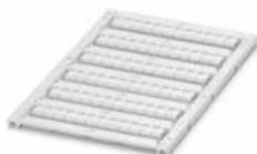
Marker für Klemmen, Matte, weiß, unbeschriftet, beschriftbar mit: TOPMARK NEO, TOPMARK LASER, BLUEMARK ID COLOR, BLUEMARK ID, BLUEMARK CLED, THERMOMARK PRIME, THERMOMARK CARD 2.0, THERMOMARK CARD, Montageart: verrasten, für Klemmenbreite: 5,2 mm, Schriftfeldgröße: 4,4 x 4,7 mm, Anzahl der Einzelschilder: 72
