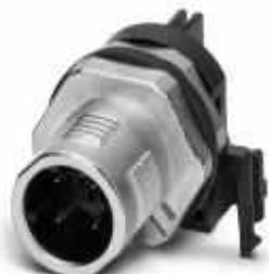
Bus-System-Einbausteckverbinder, Stecker, Ethernet, 4-polig, M12-SPEEDCON, geschirmt, D-kodiert, Hinterwand-/Schraubmontage mit M12 Gewinde, verdrehgeschützt, mit gewinkeltem Lötanschluss
