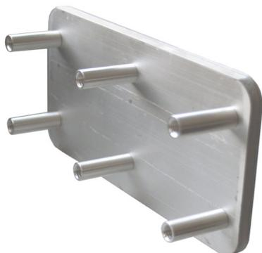
Montage-Gegenhalter 828-5 dienen dazu, an Holztüren durchgehende Verschraubungen vornehmen zu können. Dadurch wird bei der Befestigung der Haftgegenplatten an Holztüren eine größere Stabilität erreicht (nicht für Feuerschutztüren geeignet).
