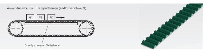
Werkstoff: Thermoplastisches Polyurethan (TPU) mit Stahlzugstrang. Mit grünem Polyamidgewebe auf der Zahnseite.
