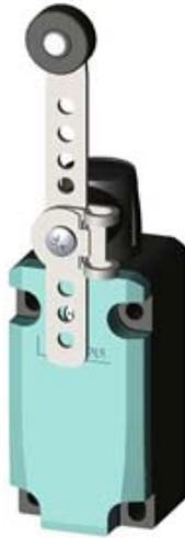
SIRIUS POSITIONSSCHALTER METALLGEHAEUSE 40MM NACH EN50041 GERAETEANSCHLUSS 1X (M20X1,5) 1S/ 2OE SPRUNGKONTAKTE SCHWENKANTRIEB RECHTS/INLKS EINSTELLBAR, MIT LAENGEN- VERSTELLB.METALLHEBEL 100MM LANG UND MIT FORMSCHLUSS (RASTERBOHRUNG), UND KUNSTSTOFFFROLLE 19MM
