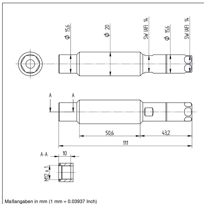
Geeignet für Kabel mit gerader Ausführung.
