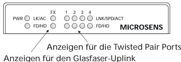
Leuchten die Act/Speed-LEDs der Twisted Pair Ports grün, wurde eine Fast Ethernet Verbindung (100 MBit) aktiviert. Für eine Ethernet Verbindung (10 MBit) leuchten diese LEDs gelb. Der Glasfaser-Uplink ist ein reiner 100Base-FX Port. Die Link-Erkennung wird mit einer grünen LED bestätigt.
