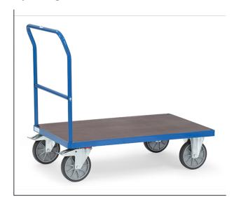
Système modulable. Ensemble mécano-soudé, revêtement époxy bleu RAL 5007. Dimensions utiles 850 x 500 mm. Avec plateforme en contreplaqué antidérapant hydrofuge. 2 roues pivotantes et 2 roues fixes à bandage TPE, moyeu à roulement à billes central. Freins sur roues pivotantes conformément à la Norme 1757-3 (Sécurité des chariots de manutention).
