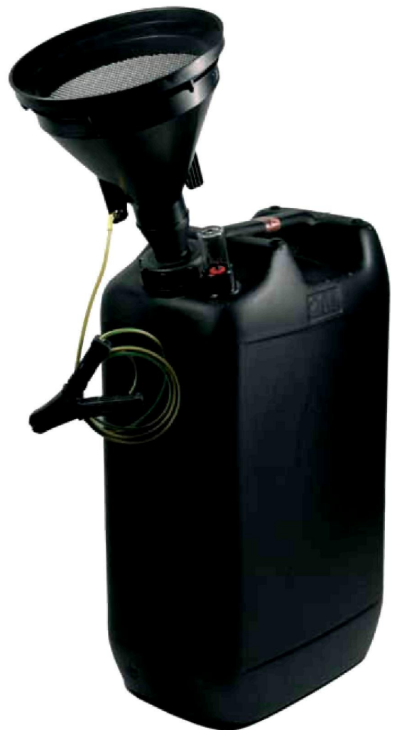
Sicherheits-Entsorgungs-Set 4 bestehend aus: Kanister (Gewinde S60), 20 Liter PE-HD leitfähig mit mechanischer Füllstandskontrolle Sicherheitstrichter PE-HD leitfähig mit Edelstahlsieb und Erdungskabel Bestell-Nr. 16978
