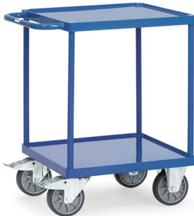
Stahlrohr und Profilstahl geschweißt, pulverbeschichtet RAL 5007. 2 Stahlblechwannen mit 10 mm hohem Rand, öldicht verschweißt, pulverbeschichtet RAL 5007. 2 Lenk- und 2 Bockrollen, TPE-Bereifung, Naben mit Rillenkugellager. Feststeller an den Lenkrollen, gemäß der Europäischen Norm EN 1757-3 (Sicherheit von Plattformwagen). Tragkraft obere Ladefläche 200 kg.
