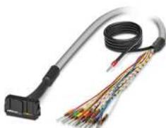
Konfektioniertes Rundkabel; Anschluss 1: Einzeladern (16-polig) (Die Adern sind beschriftet und mit Aderendhülsen versehen); Anschluss 2: IDC/FLK-Buchsenleiste (1x 16-polig); Kabellänge: variabel
