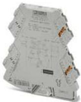
Konfigurierbarer Potipositionsmessumformer mit steckbarer Anschluss-technik für den Anschluss von Potenziometern von 0  $\Omega$  ... 100  $\Omega$  bis 0 k $\Omega$  ... 100 k $\Omega$ . Konfigurierbar über DIP-Schalter oder mittels Software. Push-in-Anschluss-technik, Standardkonfiguration
