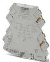
3-Wege-Trennverstärker mit steckbarer Anschlusstechnik zur galvanischen Trennung von Analogsignalen. Eingangssignal: 0 V ... 10 V, Ausgangssignal: 0 mA ... 20 mA, Push-in-Anschlusstechnik
