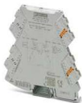
1-kanaliger eingangsschleifengespeister 2-Wege-Trenner mit steckbarer Anschlussstechnik zur galvanischen Trennung von Analogsignalen. Eingangssignal = Ausgangssignal: 0(4) mA ... 20 mA. Push-in-Anschlussstechnik.
