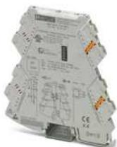
Analog-Frequenzwandler mit Grenzwertfunktionalität und steckbarer Anschluss technik zur Umsetzung von Normsignalen in Frequenz- oder PWM-Signale. Konfigurierbar über DIP-Schalter oder mittels Software. Schraubanschlusstechnik, Standardkonfiguration.
