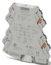
3-Wege-Trennverstärker mit steckbarer Anschluss-technik zur galvanischen Trennung von Analogsignalen. Eingangssignal: 0 V ... 10 V, Ausgangssignal: 4 mA ... 20 mA, Schraubanschlusstechnik
