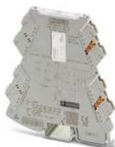
Universell-konfigurierbarer Temperaturgrenzwertschalter mit Schließerrelaisausgang für den Anschluss von 2-, 3-, 4-Leiter Widerstandsthermometern und Thermoelementen. Konfigurierbar über DIP-Schalter oder Software. Push-in-Anschlusstechnik
