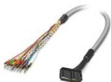
Konfektioniertes Rundkabel; Anschluss 1: Einzeladern (16-polig) (Die Adern sind beschriftet und mit Aderendhülsen versehen); Anschluss 2: IDC/FLK-Buchsenleiste (1x 16-polig); Kabellänge: 2 m
