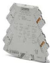
3-Wege-Speisetrenner mit steckbarer Anschlussstechnik. HART-transparent, Eingangssignal 0(4) mA ... 20 mA, Ausgangssignal 0(4) mA ... 20 mA. Das Gerät lässt sich sowohl im Trenner- als auch im Speisetrennerbetrieb verwenden. Push-in-Anschlussstechnik
