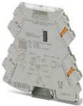
Analog-Frequenzwandler mit Grenzwertfunktionalität und steckbarer Anschluss-technik zur Umsetzung von Normsignalen in Frequenz- oder PWM-Signale. Konfigurierbar über DIP-Schalter oder mittels Software. Schraubanschlusstechnik, Bestellkonfiguration.
