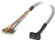
Konfektioniertes Rundkabel; Anschluss 1: Einzeladern (16-polig) (Die Adern sind beschriftet und mit Aderendhülsen versehen); Anschluss 2: IDC/FLK-Buchsenleiste (1x 16-polig); Kabellänge: 0,5 m
