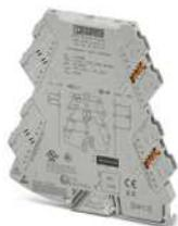
Konfigurierbarer Potipositionsmessumformer mit steckbarer Anschluss-technik für den Anschluss von Potenziometern von  $0 \Omega \dots 100 \Omega$  bis  $0 \text{ k}\Omega \dots 100 \text{ k}\Omega$ . Konfigurierbar über DIP-Schalter oder mittels Software. Schraubanschlusstechnik, Standardkonfiguration
