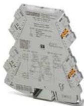
4-Wege-Speisedoppler mit steckbarer Anschlussstechnik. HART-transparent, Eingangssignal 0(4) mA ... 20 mA, Ausgangssignale 0(4) mA ... 20 mA. Das Gerät lässt sich sowohl im Signal- als auch im Speisedopplerbetrieb verwenden. Schraubanschlussstechnik.
