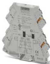
3-Wege-Trennverstärker mit steckbarer Anschlusstechnik und kalibrierter Messbereichumschaltung zur galvanischen Trennung von uni- und bipolaren Analogsignalen. Über DIP-Schalter konfigurierbarer Ein-/Ausgang. Schraubanschlusstechnik, Standardkonfiguration.
