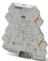
Konfigurierbarer NAMUR-Trennschaltverstärker mit steckbarer Anschluss technik für Näherungsinitiatoren, potenzialfreien und widerstandsbeschalteten Schaltkontakten. 2 Transistorausgänge, konfigurierbar über DIP-Schalter. Schraubanschlusstechnik.
