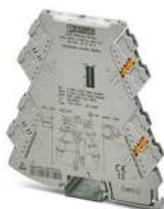
Universell-konfigurierbarer 4-Wege-Trennverstärker, mit Schaltausgang und steckbarer Anschlusstechnik zur galvanischen Trennung von Analogsignalen. Konfigurierbar über DIP-Schalter oder mittels Software. Push-in-Anschlusstechnik, Standardkonfiguration.
