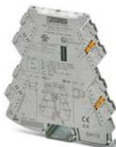
Universell, konfigurierbarer 4-Wege-Trennverstärker, mit Schaltausgang und steckbarer Anschluss Technik zur galvanischen Trennung von Analogsignalen. Konfigurierbar über DIP-Schalter oder mittels Software. Schraubanschlusstechnik, Bestellkonfiguration.
