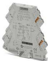
Konfigurierbarer Temperaturmessumformer mit steckbarer Anschluss technik für den Anschluss von Thermoelementen. Konfigurierbar über DIP-Schalter oder mittels Software. Push-in-Anschluss technik, Bestellkonfiguration
