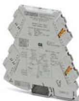
4-Wege-Speisedoppler mit steckbarer Anschluss-technik. HART-transparent, Eingangssignal 0(4) mA ... 20 mA, Ausgangssignale 0(4) mA ... 20 mA. Das Gerät lässt sich sowohl im Signal- als auch im Speisedopplerbetrieb verwenden. Push-in-Anschluss-technik.
