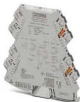
3-Wege-Speisetrenner mit steckbarer Anschluss-technik. HART-transparent, Eingangssignal 0(4) mA ... 20 mA, Ausgangssignal 0(4) mA ... 20 mA. Das Gerät lässt sich sowohl im Trenner- als auch im Speisetrennerbetrieb verwenden. Schraubanschluss-technik
