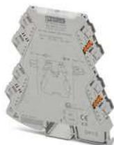
1-kanaliger eingangsschleifengespeister 2-Wege-Trenner mit steckbarer Anschlussstechnik zur galvanischen Trennung von Analogsignalen. Eingangssignal = Ausgangssignal: 0(4) mA ... 20 mA. Schraubanschlussstechnik.
