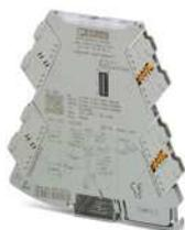
Universell-konfigurierbarer 4-Wege-Signalverdoppler, mit steckbarer Anschlussstechnik zur galvanischen Trennung und Verdopplung von Analogsignalen. Konfigurierbar über DIP-Schalter oder mittels Software. Push-in-Anschlussstechnik, Bestellkonfiguration.
