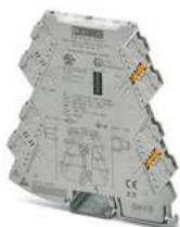
Universell, konfigurierbarer 4-Wege-Trennverstärker, mit Schaltausgang und steckbarer Anschlussstechnik zur galvanischen Trennung von Analogsignalen. Konfigurierbar über DIP-Schalter oder mittels Software. Push-in-Anschlussstechnik, Bestellkonfiguration.
