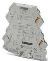
Konfigurierbarer Temperaturmessumformer mit steckbarer Anschluss technik für den Anschluss von 2-, 3-, 4-Leiter Widerstandsthermometern und -gebern. Konfigurierbar über DIP-Schalter oder mittels Software. Schraubanschlusstechnik, Standardkonfiguration
