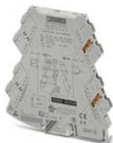
Konfigurierbarer Temperaturmessumformer mit steckbarer Anschluss-technik für den Anschluss von Thermoelementen. Konfigurierbar über DIP-Schalter oder mittels Software. Schraubanschlusstechnik, Bestellkonfiguration
