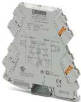
3-Wege-Trennverstärker mit steckbarer Anschluss technik zur galvanischen Trennung von Analogsignalen. Eingangssignal: 0 V ... 10 V, Ausgangssignal: 4 mA ... 20 mA, Push-in-Anschlusstechnik
