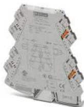
3-Wege-Trennverstärker mit steckbarer Anschluss Technik zur galvanischen Trennung von Analogsignalen. Eingangssignal: 0(4) mA ... 20 mA, Ausgangssignal: 0(4) mA ... 20 mA, Schraubanschlusstechnik
