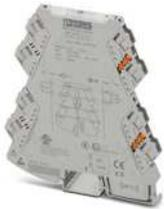
3-Wege-Trennverstärker mit steckbarer Anschluss technik zur galvanischen Trennung von Analogsignalen. Eingangssignal: 0 V ... 10 V, Ausgangssignal: 0 mA ... 20 mA, Schraubanschlusstechnik
