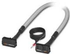
Konfektioniertes, geschirmtes Rundkabel; Anschluss 1: IDC/FLK-Buchsenleiste (1x 16-polig); Anschluss 2: IDC/FLK-Buchsenleiste (1x 16-polig) (Das Schirmgeflecht ist auf ein separates Kabelende herausgeführt.); Kabellänge: 4 m
