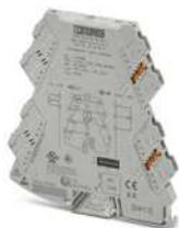
Konfigurierbarer Potipositionsmessumformer mit steckbarer Anschluss-technik für den Anschluss von Potenziometern von  $0 \Omega \dots 100 \Omega$  bis  $0 \text{ k}\Omega \dots 100 \text{ k}\Omega$ . Konfigurierbar über DIP-Schalter oder mittels Software. Schraubanschlusstechnik, Bestellkonfiguration
