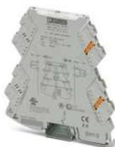
3-Wege-Trennverstärker mit steckbarer Anschluss-technik zur galvanischen Trennung von Analogsignalen. Eingangssignal: 0(4) mA ... 20 mA, Ausgangssignal: 0(4) mA ... 20 mA, Push-in-Anschlusstechnik.
