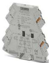
3-Wege-Trennverstärker mit steckbarer Anschlusstechnik und kalibrierter Messbereichumschaltung zur galvanischen Trennung von uni- und bipolaren Analogsignalen. Über DIP-Schalter konfigurierbarer Ein-/Ausgang. Push-in-Anschlusstechnik, Bestellkonfiguration.
