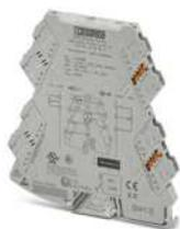
Konfigurierbarer Potipositionsmessumformer mit steckbarer Anschluss-technik für den Anschluss von Potenziometern von  $0 \Omega \dots 100 \Omega$  bis  $0 \text{ k}\Omega \dots 100 \text{ k}\Omega$ . Konfigurierbar über DIP-Schalter oder mittels Software. Push-in-Anschluss-technik, Bestellkonfiguration
