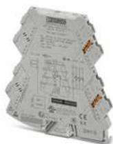
Konfigurierbarer Temperaturmessumformer mit steckbarer Anschluss technik für den Anschluss von 2-, 3-, 4-Leiter Widerstandsthermometern und -gebern. Konfigurierbar über DIP-Schalter oder mittels Software. Push-in-Anschluss technik, Bestellkonfiguration
