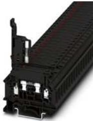
Sicherungsreihenklemme, Art der Sicherung: Glas / Keramik / ..., Sicherungstyp: G / 5 x 20, Nennspannung: 24 V, Nennstrom: 6,3 A, Polzahl: 1, Anschlussart: Schraubanschluss, Bemessungsquerschnitt: 1,5 mm<sup>2</sup>, Querschnitt: 0,2 mm<sup>2</sup>- 6 mm<sup>2</sup>, Montageart: NS 35/7,5, NS 35/15, NS 32, Farbe: schwarz
