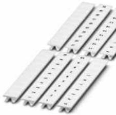
Zackband, Streifen, weiß, beschriftet, beschriftbar mit: CMS-P1-PLOTTER, längs bedruckt: fortlaufende Zahlen 1 ... 10, 11 ... 20 usw. bis 91 ... 100, Montageart: verrasten, für Klemmenbreite: 8,2 mm, Schriftfeldgröße: 10,5 x 8,15 mm, Anzahl der Einzelschilder: 10
