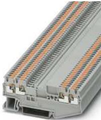
Durchgangsklemme, konturgleich zur Trennklemme, Nennspannung: 400 V, Nennstrom: 17,5 A, Anschlussart: Push-in-Anschluss, 1. Etage, Bemessungsquerschnitt: 1,5 mm<sup>2</sup>, Querschnitt: 0,14 mm<sup>2</sup> - 1,5 mm<sup>2</sup>, Montageart: NS 35/7,5, NS 35/15, Farbe: grau
