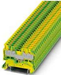
Schutzleiter-Reihenklemme, Anzahl der Anschlüsse: 4, Anschlussart: Push-in-Anschluss, Bemessungsquerschnitt: 2,5 mm<sup>2</sup>, Querschnitt: 0,14 mm<sup>2</sup> - 4 mm<sup>2</sup>, Montageart: NS 35/7,5, NS 35/15, Farbe: grün-gelb
