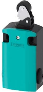
Positionsschalter 3SE5162 Metallgehäuse XL, 56 mm breit mit Rollenhebel, Metallhebel und Kunststoffrolle 22 mm Geräteanschluss 3 x (M20 x 1,5) 2 x (1S/1Ö) Schleichschaltglieder IP66/IP67
