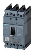
Leistungsschalter 3VA5 UL Frame 125 3-polig, Starterschutz TM120M, AM, In=30A ohne Überlastschutz Kurzschlussschutz Ii=5...12 x In ohne Anschluss
