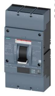
Leistungsschalter 3VA6 UL Frame 1000 Schaltvermögenklasse H 65kA @ 480 V 3-polig, Anlagenschutz ETU560, LSIG, In=1000A Überlastschutz Ir=400A ...1000A Kurzschlussschutz Isd=0,6..10x In, Ii=1,5..10x In N-Leiterschutz optional mit ext. CT bis 160% Erdschlussschutz Ig=0,2... 1 x In, tg=0,05-0,8s beidseitig Kabelanschluss
